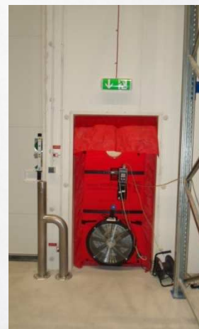
Rys. 1. Urządzenie Blower Door w miejscu drzwi zewnętrznych
